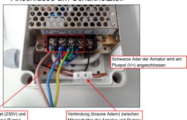
Vorverdrahtung Netzkabel (230V) und blaue Ader (Klemme V-) zur Pumpe
